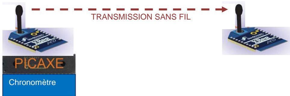
Ce test vérifie qu'un PIC peut envoyer les données sur une transmission sans fil. Le module XBee avec un PIC18X envoie un chronomètre à un autre module XBee qui le retransmet à l'ordinateur.
