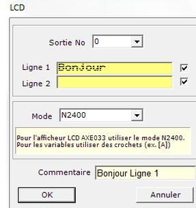
Cette fenêtre permet de configurer la sortie utilisée et le texte à afficher sur l'écran.
