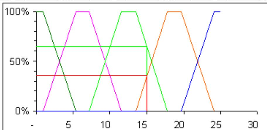
Un autre exemple de modélisation, ici ce sont des trapèzes qui sont utilisés, mais des triangles ou d'autres courbes sont utilisées. Elles doivent cependant vérifier que la somme des probabilités associées à un point est égale à 1. Dans ce cas si l'axe représente une température d'automne la courbe verte pourrait représenter la modalité "normale" et l'orange "chaud".
