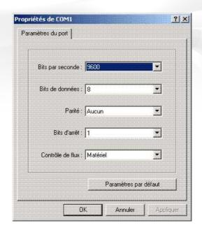
Une fois connecter la fenetre d'hyperterminal se remplira de "Ok" à n'en plus finir
